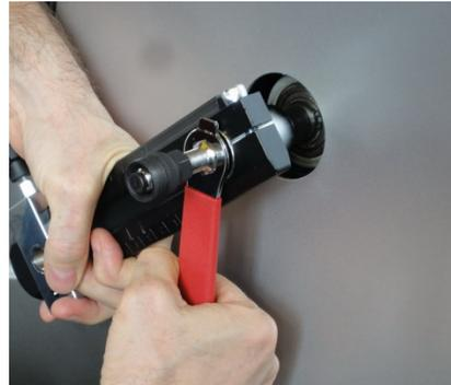
5. Installez et serrez les pédales. C'est beaucoup plus facile de serrer les pédales si l'extrémité opposée de la clef est orientée vers l'axe du pédalier tel que dans l'illustration ci-dessous. Si la clef est orientée dans l'autre sens, c'est très difficile de serrer la pédale fermement. La même chose s'applique pour serrer l'écrou de l'essieu à l'étape 4 ci-dessus.
