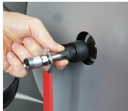
3. Taraudez le boulon argenté complètement dans le baril noir jusqu'à ce qu'il s'arrête. Placez la clef rouge dans la partie hexagonale du baril argenté et tournez dans le sens des aiguilles d'une montre jusqu'à ce que le bras de manivelle soit desserré. Enlevez le bras de manivelle.
